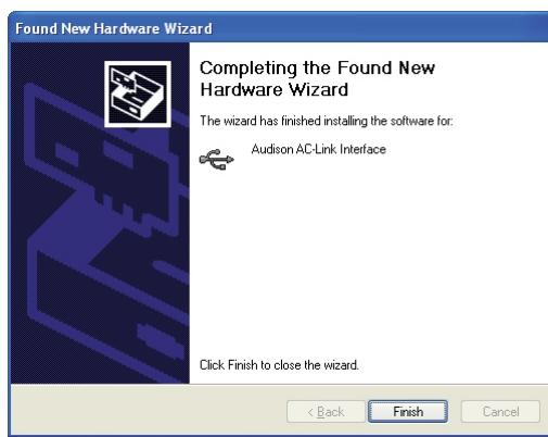
13 - После этого “опознает” Bit One как новое устройство, подключенное через USB порт и запросит разрешение на установку соответствующего драйвера:
