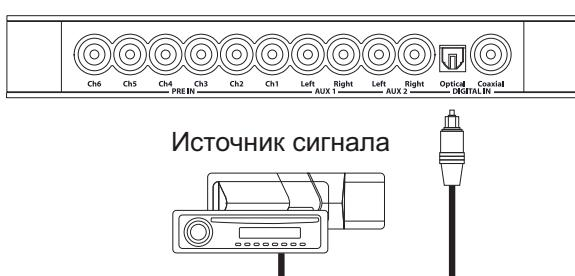
Предупреждение: цифровые входы могут работать с сигналами до 192 кГц/24-бит стерео PCM. Таким образом, Bit One не декодирует мультимедийные звуковые дорожки, записанные в форматах 5.1 (DOLBY DIGITAL, dts).
